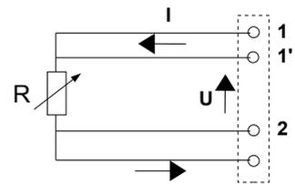
On fait passer un courant constant par les bornes 1' et 2' et l'on mesure directement la tension aux bornes de l'élément sensible, ce qui permet complètement de s'affranchir des résistances de lignes. C'est le montage le plus précis.
