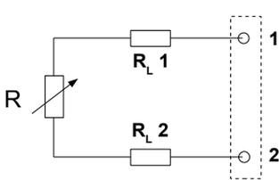
C'est la méthode la plus simple, mais les résistances de ligne (RL1 et RL2) sont en série avec l'élément sensible. L'erreur correspond à  $RL1 + RL2$ , d'où un décalage de la température mesurée et de la température réelle. C'est le montage à éviter.
